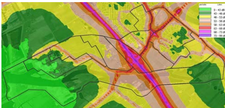
Figuur 3.2 Geluidbelasting wegverkeerslawaai in dB op 7,5 meter hoogte in de referentiesituatie (excl. aftrek artikel 110g Wet geluidhinder)
